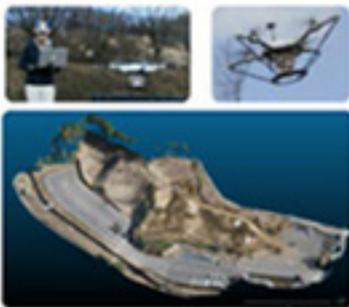
ドローン等による写真測量等により、短時間で面的(高密度)な3次元測量を実施
